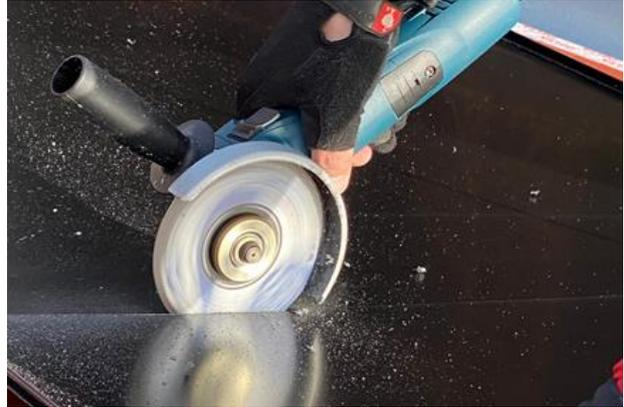
Fig. 11: Découpe avec une scie circulaire Flex
